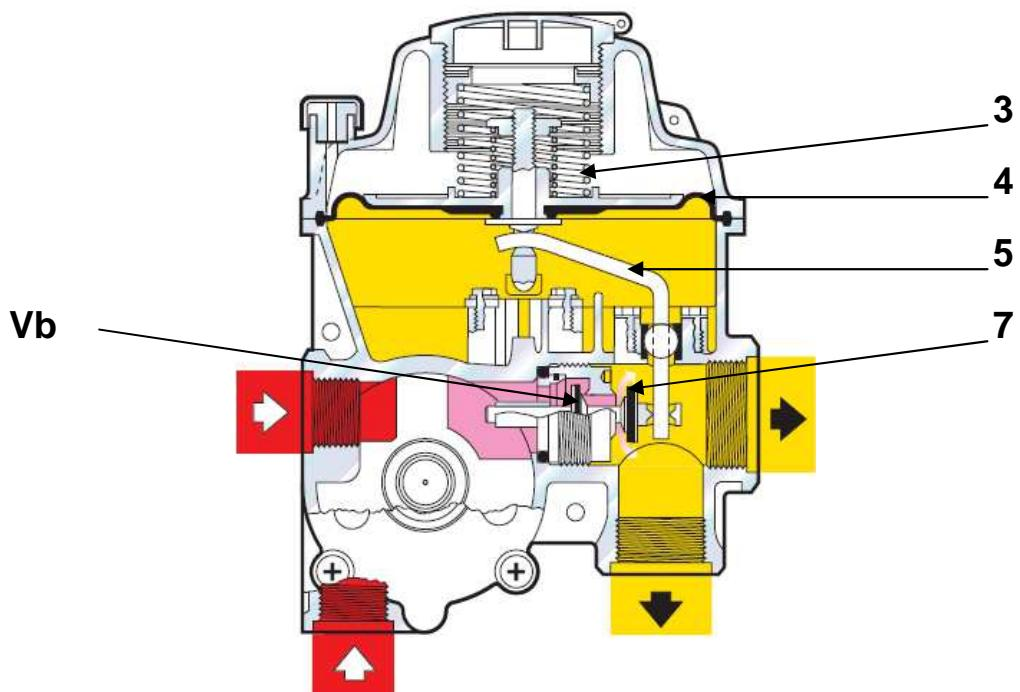
Изменения давления, увеличение или уменьшение, обусловленные большим или меньшим расходом, зарегистрированные посредством отбора импульса в камере **B**, изменяют равновесие, созданное между усилием, оказываемом на мембрану **4** и усилием противодействия пружины **3**, удаляя или приближая уплотнение **7** седла клапана **Vb**, выводя его на то положение, что позволит восстановить равновесие между двумя противодействующими усилиями, приводя, как следствие, давление к настроенным уровням.
