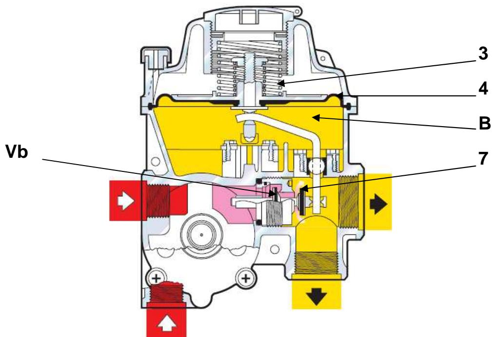
Газ при требуемом настроочном давлении выходит из регулятора к потребителям через выходные фитинги **U**.
